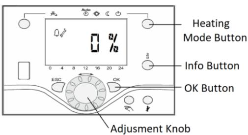
Настройка выбросов при минимальной нагрузке производится путем измерения содержания CO<sub>2</sub> в дымовых газах. Чтобы принудительно перевести котел на минимальную мощность необходимо выполнить следующие шаги.
