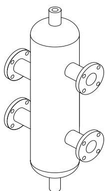
Гидравлический разделитель применяется для компенсации перепадов давления в системах, где используется несколько насосов и/или контуров отопления, для устранения чрезмерной разницы давлений и температур воды на входе и выходе котла и для предотвращения тепловых напряжений в кotle.
