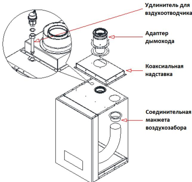
Если в котлах модели WALLCON X-treme применяется соединение дымохода типа С13, С33 (коаксиальный); Используйте комплект из удлинителя воздухоотводчика, адаптера дымохода 80/125, коаксиальной надставки 80/125 и соединительной манжеты 80 мм.
