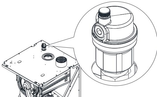
Водогрейные конденсационные котлы **WALLCON X-treme 42-80 кВт** оборудованы автоматическими воздухоотводчиками.
