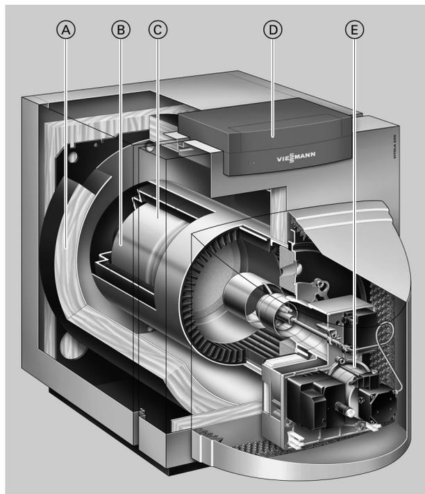
Надежное и экономное отопление обеспечивается биферральными комбинированными поверхностями нагрева из чугуна и стали. В сочетании с широкими проходами секций и большим водонаполнением они обеспечивают эффективную передачу тепла. Чтобы сократить до минимума потери тепла, водогрейный котел и емкостный водонагреватель защищены высокоэффективной теплоизоляцией.
