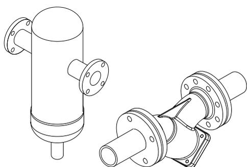
Для удаления грязи и взвешенных частиц из теплоносителя на обратном трубопроводе (перед котлом) следует установить сетчатый фильтр или сепаратор шлама.
