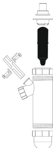
Конденсат, образующийся в процессе сгорания, сливается в систему канализации через сифон и дренажный шланг. Подключение дренажного шланга к системе канализации должно быть выполнено с разрывом струи.
