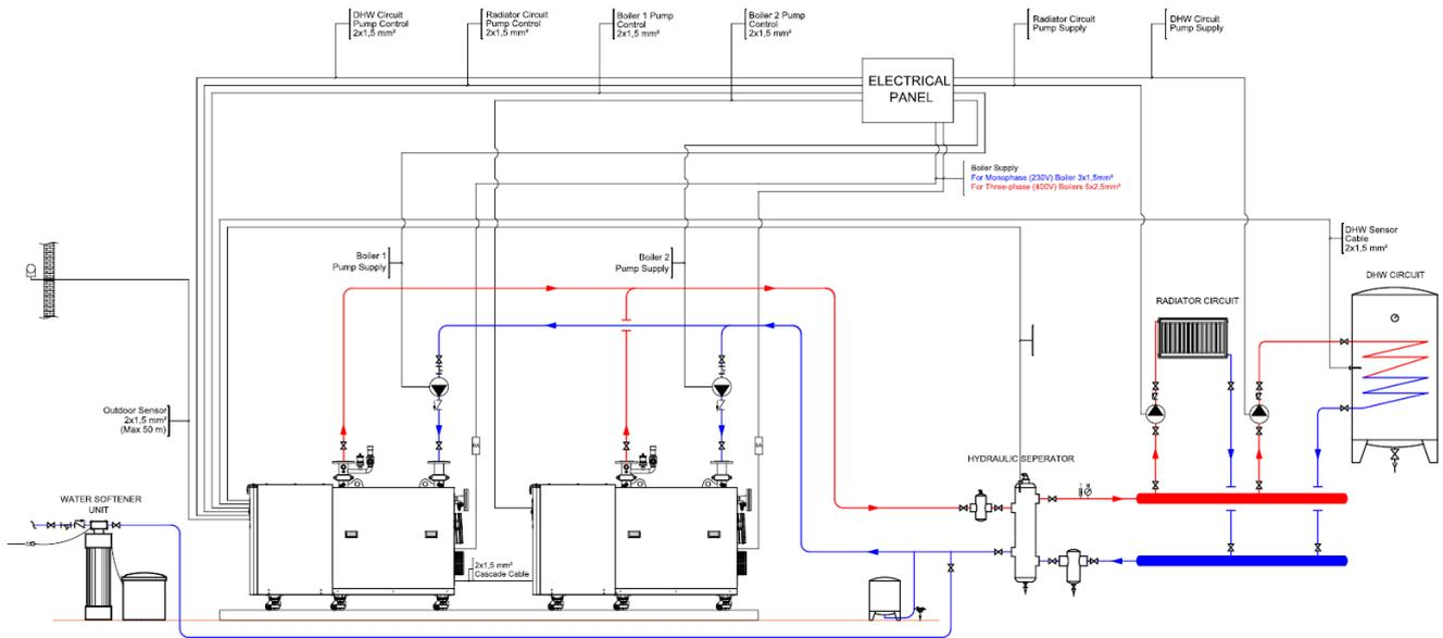
**Установка из 2 котлов в каскаде с 1 контуром радиаторного отопления, 1 контуром теплого пола и контуром ГВС с разделительным теплообменником**
