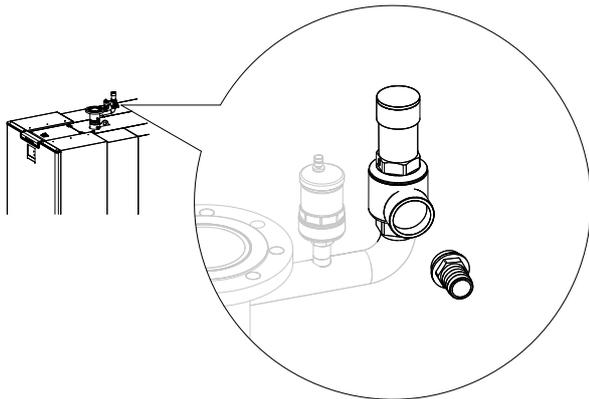
**ULTRABOX** оборудован встроенным предохранительным клапаном. Дренажный шланг от предохранительного клапана должен быть подключен к системе канализации.
