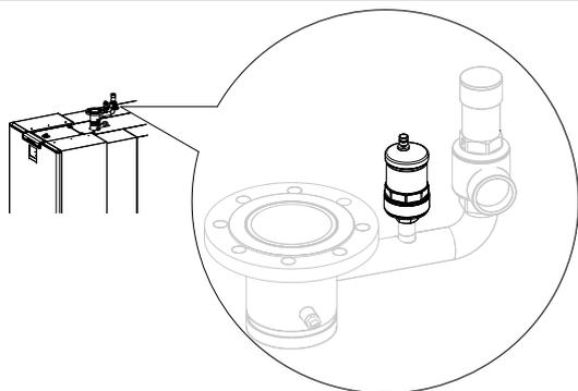
Водогрейные конденсационные котлы **ULTRABOX** оборудованы автоматическими воздухоотводчиками.
