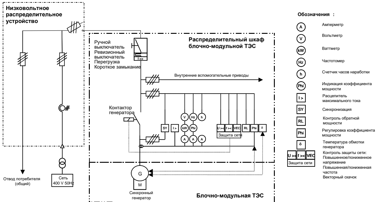
Рис. 4 Принципиальная схема электрических соединений блочно-модульной ТЭС для режима параллельной работы в сети
