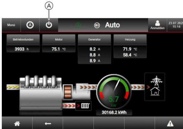
Ⓐ Выключение блочно-модульной ТЭС
