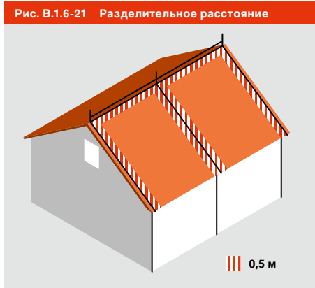
При монтаже коллекторов необходимо соблюдать безопасное расстояние до молниеотвода.
