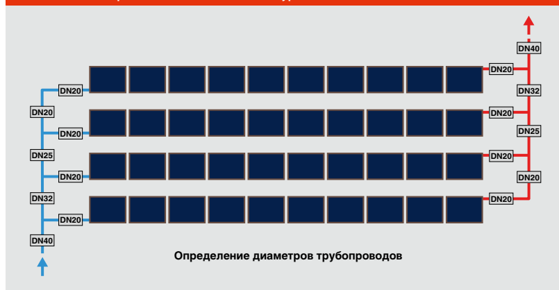
Рис. С.1.2-6 Скорость теплоносителя в контурах гелиополя
