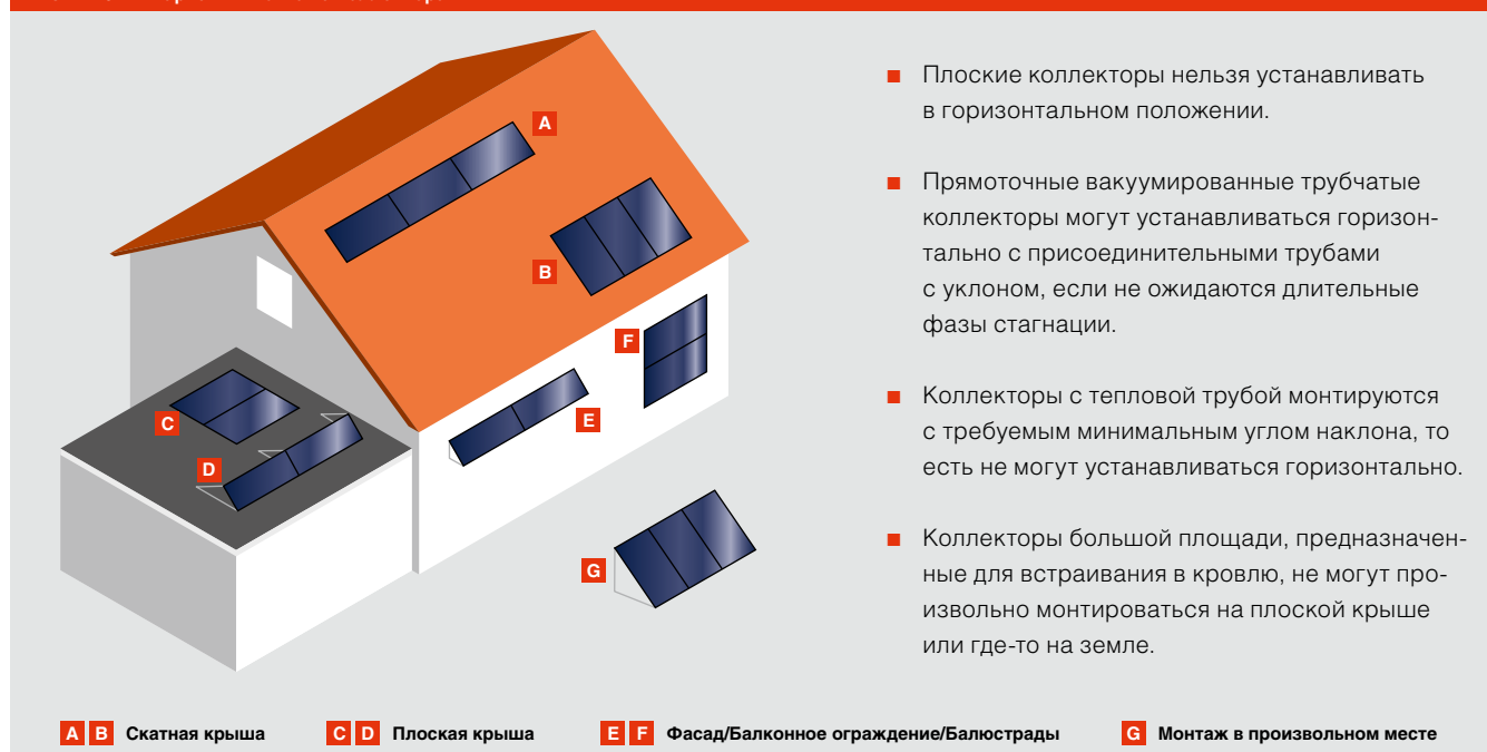
Рис. В.1.6-1 Варианты монтажа коллектора
