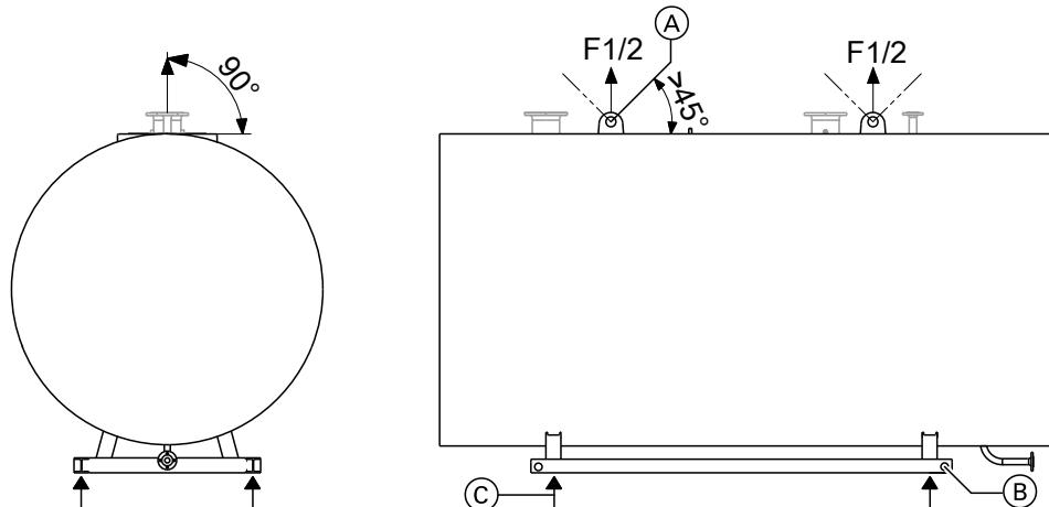
Рис. 1 Возможности крепления
