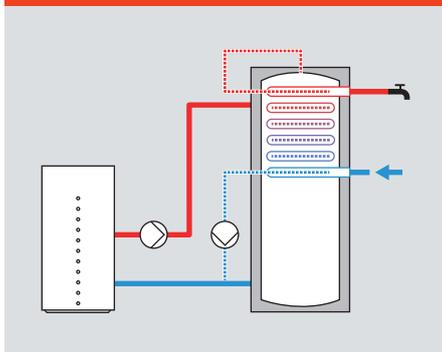
При больших расходах горячей воды или небольшом перепаде температуры производительность увеличивается с дополнительным циркуляционным насосом
