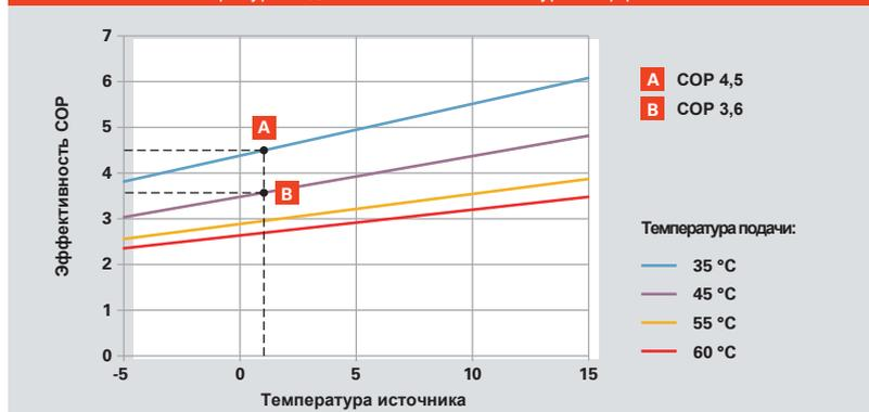
При той же температуре первичного источника повышение температуры подачи снижает COP.
