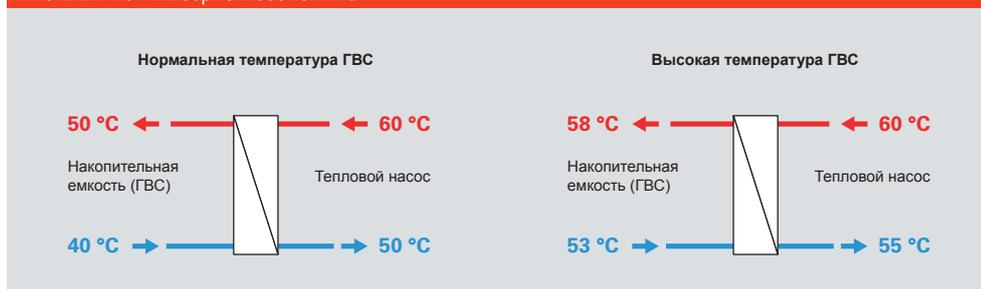
Внешние теплообменники пластинчатого типа особенно хороши при больших расходах ГВС.
