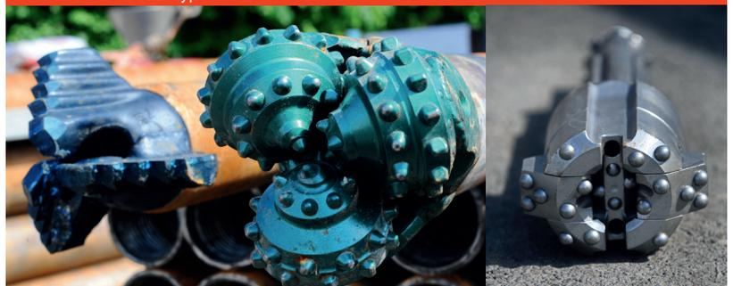
В зависимости от типа породы и глубины скважины используются различные виды буров.
