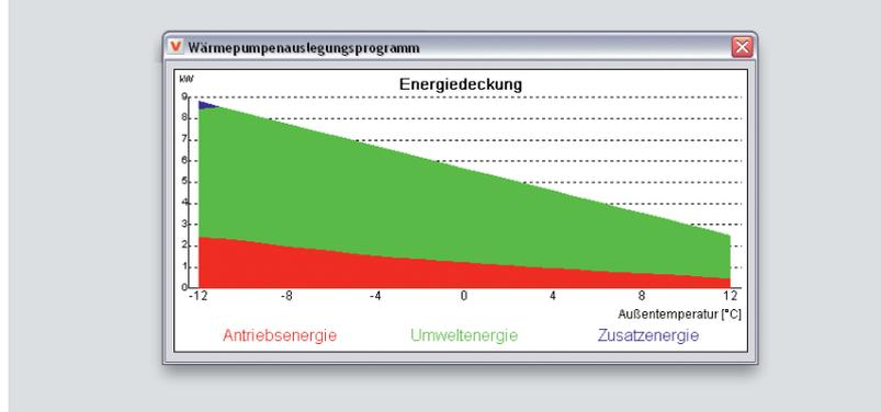
Наряду с определением расчетного значения числа годовой наработки теплового насоса согласно VDI 4650, можно определить возможную долю участия в покрытии этой нагрузки альтернативных источников энергии.
