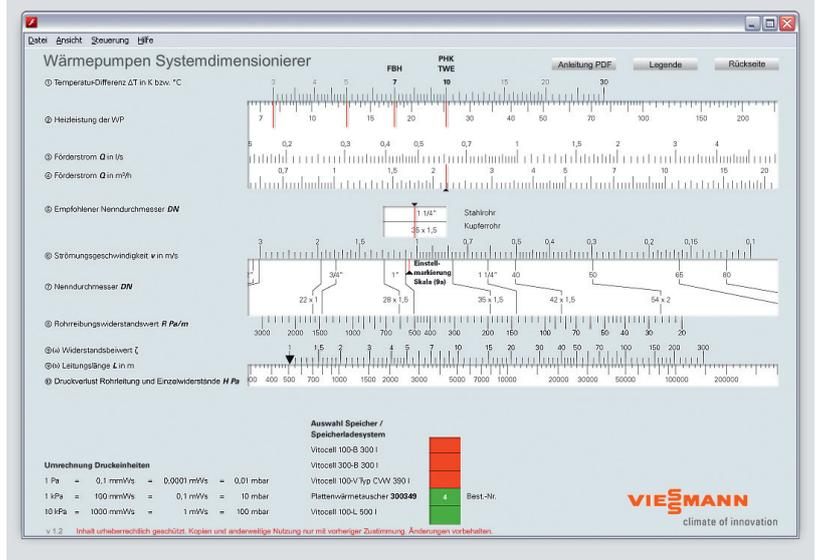
**Рис. D.3.2-4** Пример программы расчета тепловых насосов
