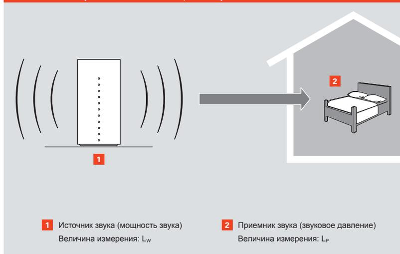
Мощность звука зависит от источника, а ухо улавливает звуковое давление.
