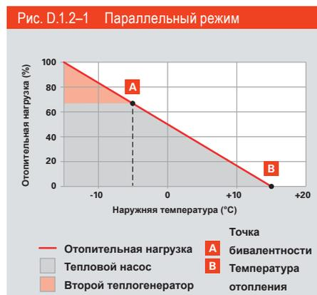
Тепловой насос является либо единственным источником тепла (рис. D.1.1–1) либо обеспечен поддержкой второго теплогенератора (рис. D.1.2–1).
