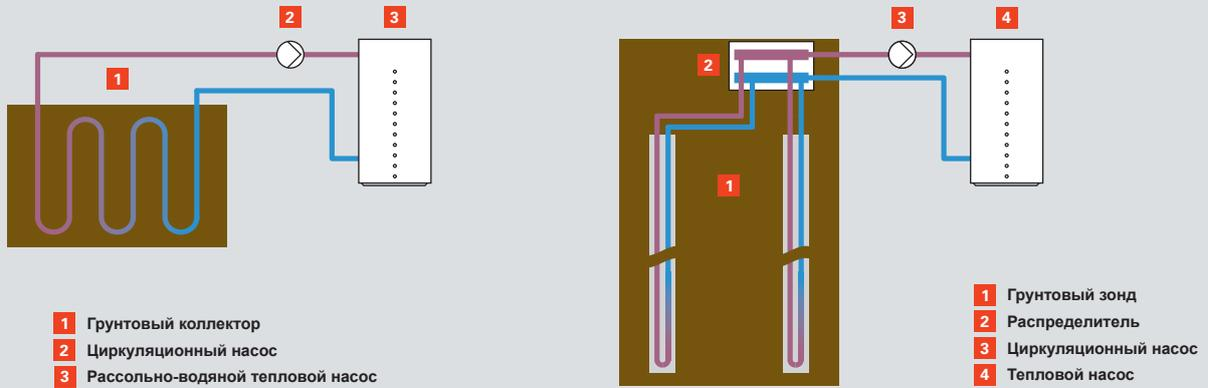
Рассольно-водяной тепловой насос в качестве первичного источника тепла использует энергию грунта (грунтовые коллекторы или грунтовые зонды).
