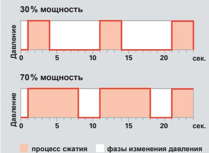
частоту вращения спирали компрессора. Инверторное управление очень эффективно при частичных нагрузках.
