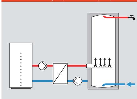
регулирование температуры происходит в узком диапазоне. Размер пластинчатого теплообменника рассчитывается заранее с помощью соответствующих программ.
