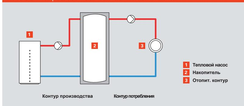
Параллельно включенная накопительная емкость может служить гидравлической стрелкой.
