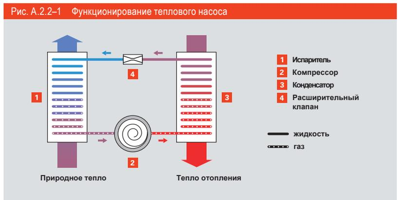
Хладагент при низких температурах испаряется и поглощает при этом тепло. Сжатие повышает температуру пара, а последующая конденсация позволяет высвободить накопленное тепло.
