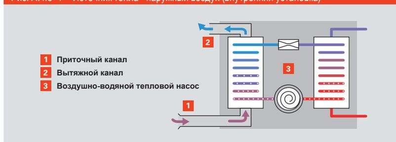
Так как теплообменники воздушно-водяных тепловых насосов обеспечивают большой расход воздуха (3 000 до 4 500 м<sup>3</sup>/ч), необходимо предусмотреть правильное расположение воздухозаборников для создания комфортных условий проживания.
