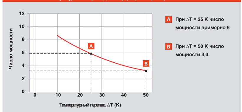
Для того чтобы дать значения производительности теплового насоса определяемое в любой точке рабочего процесса, необходимо воспользоваться базовыми нормами по DIN EN 14511. Температура рабочей точки принимается за отношение температуры первичного источника тепла (воздух А, рассол В, вода W) к температуре выдаваемой тепловым насосом в контур отопления.
