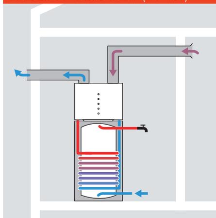
Тепловой насос может также выступать в режиме простой механической вентиляции для нагрева воды.
