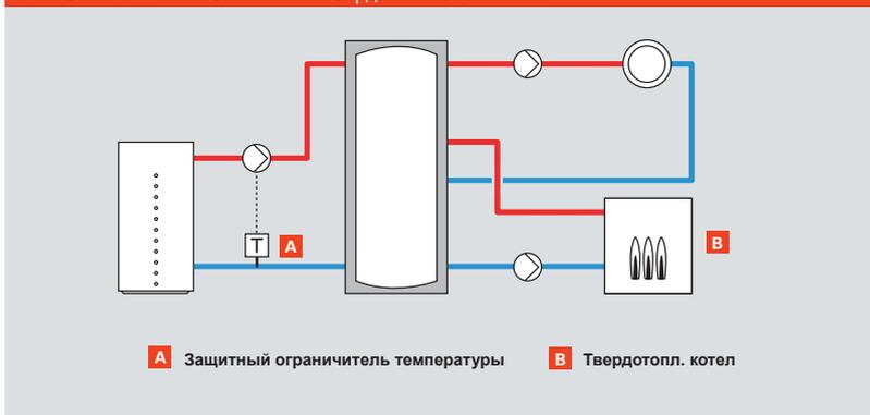
Применение твердотопливного котла в системе с тепловым насосом.
