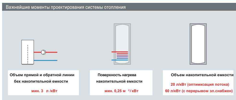
После определения необходимой отопительной нагрузки и выбора первичного источника тепла важным этапом является выбор между моновалентной и бивалентной схемой теплоснабжения. Бивалентная схема предусматривает использование электронагревательных элементов для пиковых режимов отопления или подготовки горячей воды необходимого уровня температуры.
