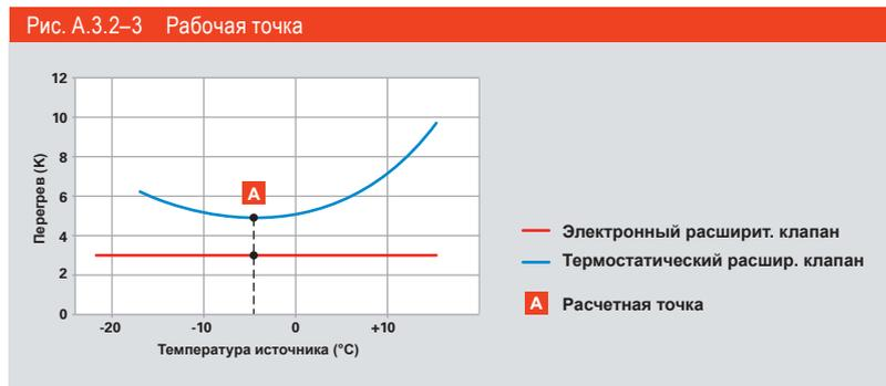
Электронный расширительный клапан регулирует быстро и точно во всем диапазоне рабочей мощности теплового насоса. Термостатический расширительный клапан осуществляет регулировку только в расчетной точке, в других точках не исключен перегрев.
