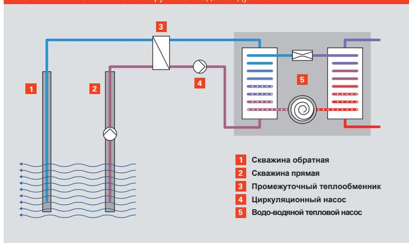
первичного контура к рассолу внутреннего контура теплового насоса. Тем самым, тепловой насос оказывается надежно защищенным.
