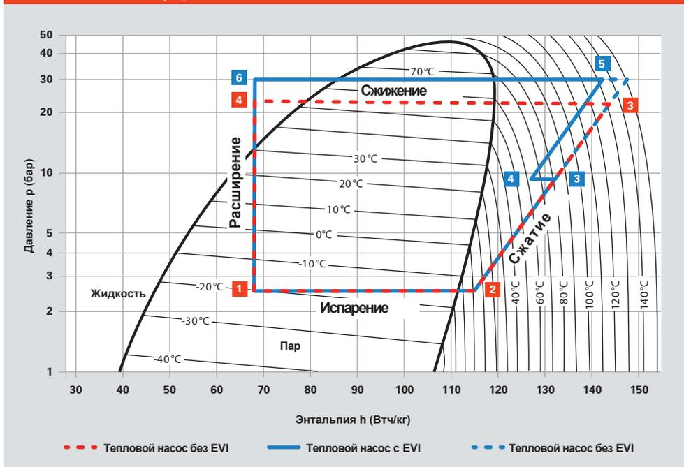
Тепловой насос без промежуточного впрыска EVI (красная линия) при минимальной температуре источника  $-10\text{ }^{\circ}\text{C}$  обеспечивает температуру подачи не выше  $55\text{ }^{\circ}\text{C}$ , так как процесс сжатия завершается при температуре  $135\text{ }^{\circ}\text{C}$ . Благодаря промежуточному впрыску пара (от 3 до 4; голубая линия) давление возможно повысить без перегрева хладагента. Благодаря этому может быть достигнута температура подачи  $65\text{ }^{\circ}\text{C}$ .
