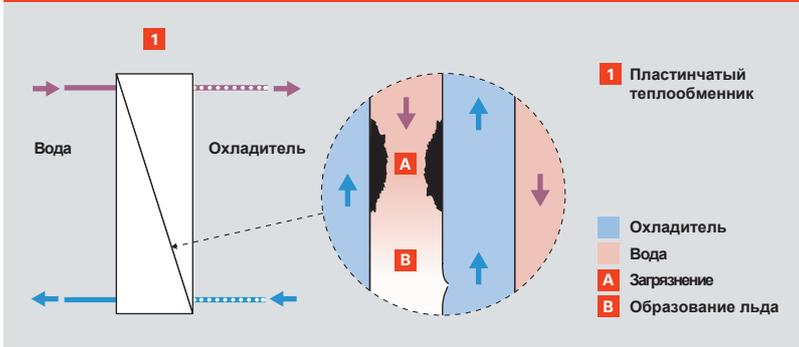
Локальные загрязнения вызывают эффект "ледяной пробки", когда образовавшееся снижение скорости течения и частички грязи способствуют замораживанию воды и нарастания "ледяной шубы". Таким образом теплообменник теряет свою герметичность, что приводит к выходу из строя всей установки в целом.
