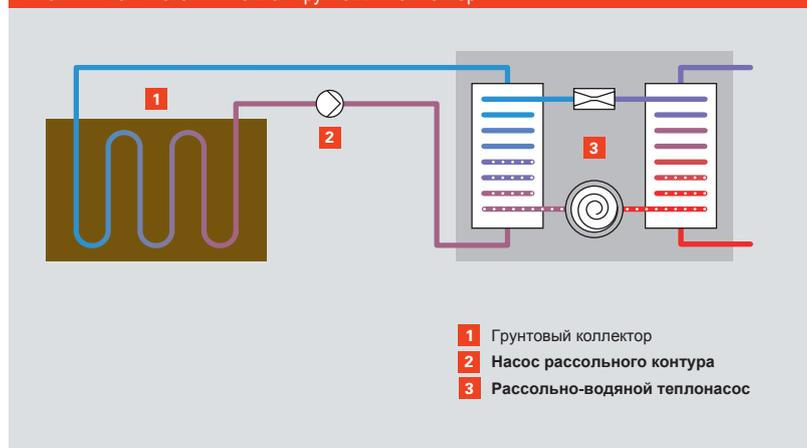
Площади земли, находящиеся над проложенными грунтовыми коллекторами должны, по возможности, иметь минимальную застройку и затенение, чтобы полноценно регенерировать в течение теплого времени года. Солнечное излучение и осадки должны обеспечивать полную регенерацию грунта, чтобы к началу отопительного периода он был готов отдавать накопленное тепло.
