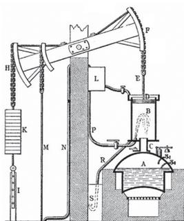
Рис. А.1-1 Паровая машина
