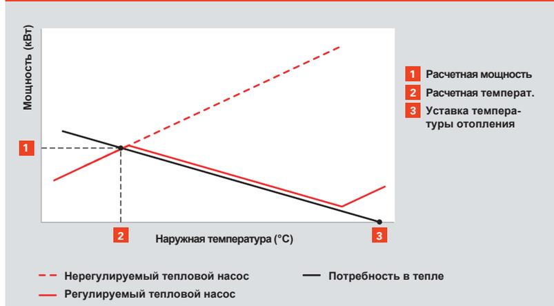
Регулирование мощности теплового насоса для предотвращения частого тактирования
