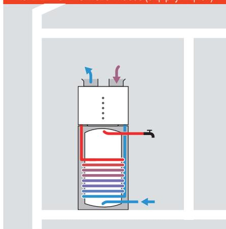
Воздушно-водяные тепловые насосы с циркуляцией воздуха используют тепло, содержащееся в воздухе помещения, дополнительно осушая его.
