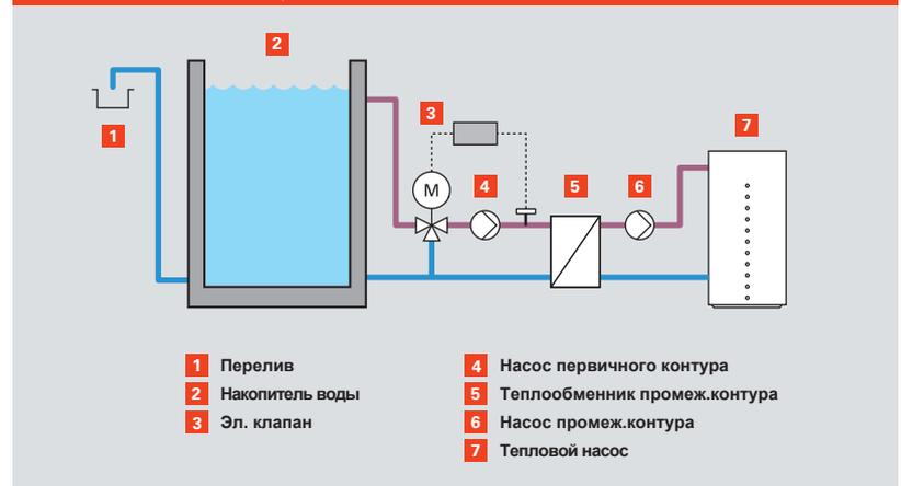
Использование охлаждающей воды с организацией промежуточного контура.
