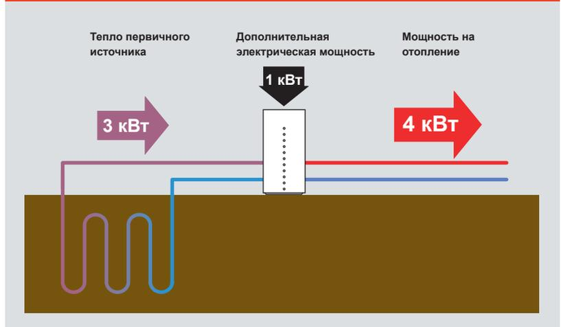
Тепловая мощность в данном случае превышает в 4 раза мощность подведенной электрической энергии.
