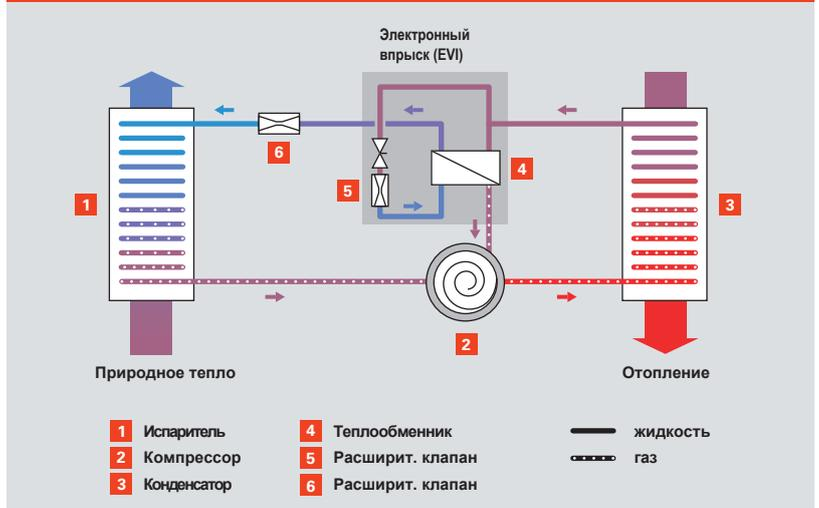
После процесса сжижения (3) часть хладагента с помощью промежуточного теплообменника (4) и экспанзионного расширительного клапана (5) используется для создания пара для дополнительного впрыска напрямую в компрессор (2). Это происходит в момент завершающей фазы сжатия, примерно во второй ее трети. Благодаря этому происходит охлаждение уплотненного сжатием хладагента.
