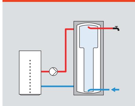
Рис. D.2–18 Змеевиковый теплообменник
