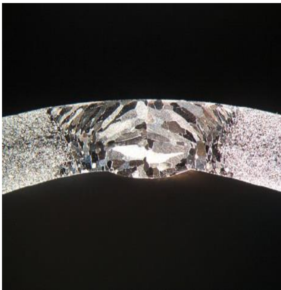
Макросъемка, сварной шов WIG EN 1.4521
