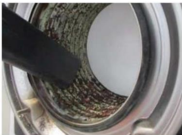
1. Предварительно убрать пылесосом отложения.
