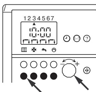
Нажать клавишу „1-7“ и повернуть врачающуюся ручку „ $- \leftarrow +$ “ таким образом, чтобы стрелка „▲“ на день недели (1 = понедельник, 2 = вторник и т.д.), для которого требуется опросить и изменить моменты включения и выключения.
