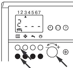
1. Одновременно нажать красную „○“ и синюю „●“ клавиши под соответствующим условным обозначением; на пять секунд появляется цифра „!<sup>1</sup>“. Цифра „!<sup>1</sup>“ обозначает первую циклограмму переключения режимов.
