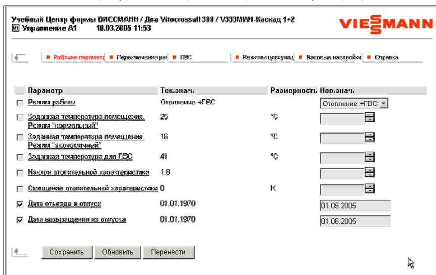
Актуальность отображаемых параметров может быть оценена по отметке времени их считывания в заголовке окна(верхний колонтитул правого фрейма), при условии, что опрос/изменения производились через систему Vitodata. Если ранее уставка параметров производились не через Vitodata, а непосредственно локально на контроллере в Котельной, то будет отображен результат последнего опроса/изменения, производимого через Vitodata.
