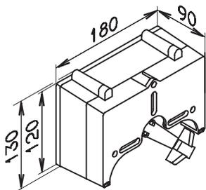
Привод смесителя может монтироваться непосредственно на смесителе фирмы Viessmann Ду 20 – Ду 50 и R 1/2 – R 1 1/4. Привод смесителя это реверсивный однофазный синхронный электродвигатель с редуктором и двумя концевыми выключателями.
