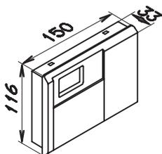
Для установки в контроллер, если блок управления контроллера используется в качестве пульта дистанционного управления. Индикация температуры котловой воды и сигнализация неисправностей.
