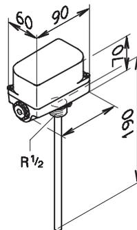
Термостат встраивается в подающую магистраль и отключает циркуляционный насос контура при слишком высокой температуре подачи.
