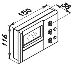
Для установки в настенную панель в качестве пульта дистанционного управления для контроллера Dekamatik. Могут использоваться все функции блока управления Comfortrol. Необходимо задать: на какой отопительный контур будет воздействовать блок управления, используемый в качестве пульта дистанционного управления.
