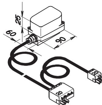
С соединительным кабелем (длиной ок. 4 м и 0,8 м) и системным штекером.
