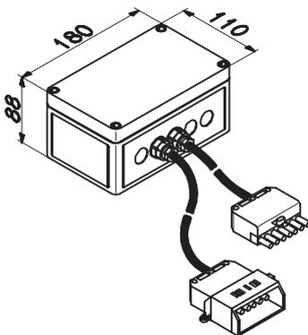
С кабелем (длиной 0,8 м и 3,3 м) и штекерным соединителем <sup>41</sup>.
