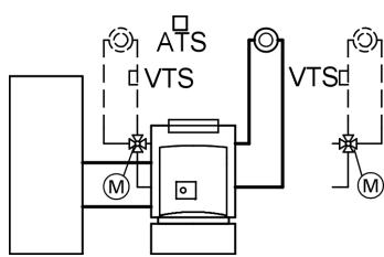
Контроллер погодозависимого цифрового программного управления котловым контуром и отопительными контурами:
