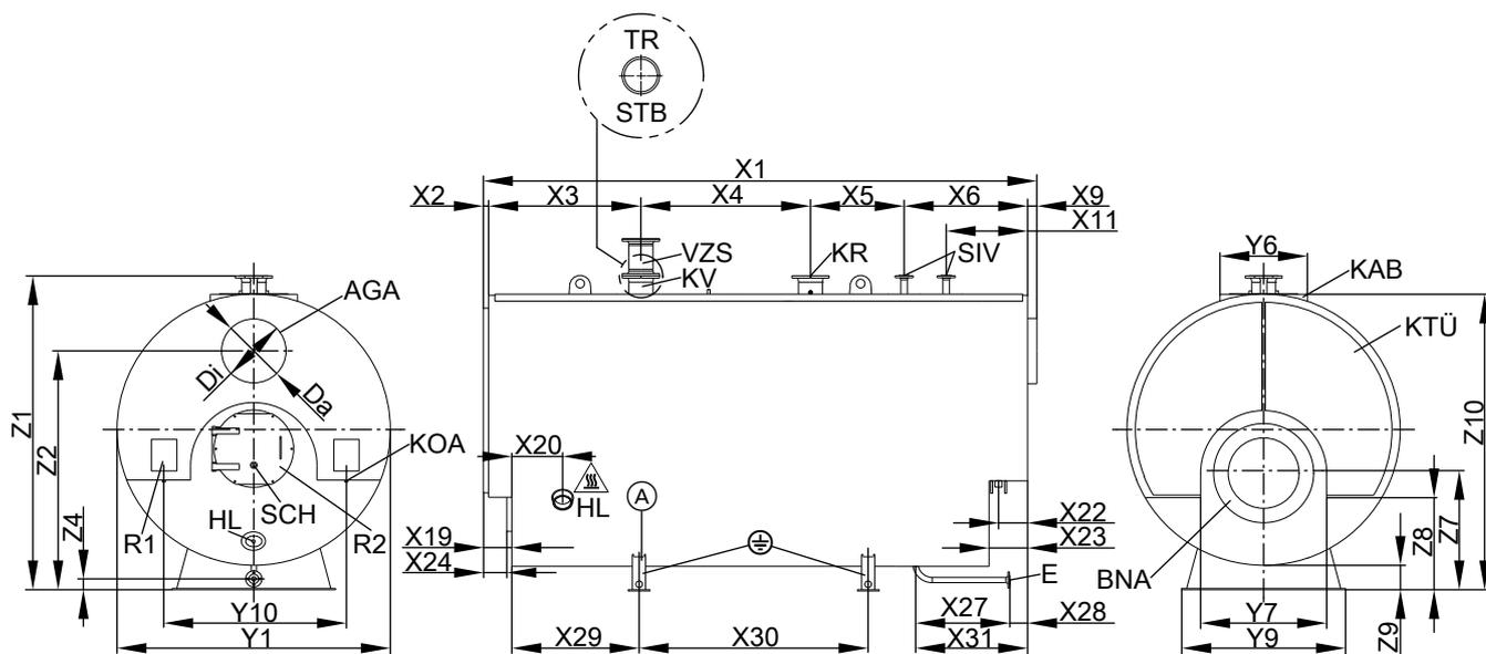
Типоразмер котла 1 - 2 – конструкция с поперечной планкой и балкой из широкополочного двутаврового профиля, начиная с тепло-размера котла 3 – конструкция с продольными балками из широкополочного двутаврового профиля
