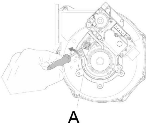
Поворачивайте винт регулировки объема подаваемого газа в номинальном режиме (A) по часовой стрелке для увеличения значения CO<sub>2</sub>. Если поворачивать этот винт против часовой стрелки, то расход газа будет уменьшаться и, таким образом, будет уменьшаться и значение уровня CO<sub>2</sub>.
