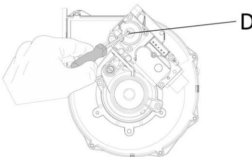
Поверните винт регулировки минимального расхода газа (D) по часовой стрелке, чтобы увеличить значение CO<sub>2</sub>. Если вы повернете его против часовой стрелки, расход газа уменьшится и, следовательно, количество CO<sub>2</sub> тоже уменьшится.
