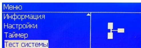
Настройка выбросов при минимальной нагрузке производится путем измерения содержания CO<sub>2</sub> в дымовых газах. Чтобы принудительно перевести котел на минимальную мощность необходимо выполнить следующие шаги.
