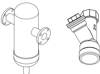
Для удаления грязи и взвешенных частиц из теплоносителя на обратном трубопроводе (перед котлом) следует установить сетчатый фильтр или сепаратор шлама.
