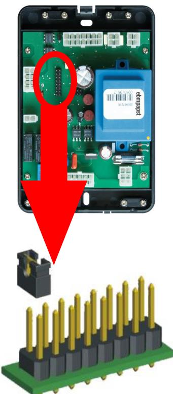
**Установка перемычек для многоконтурных систем**
