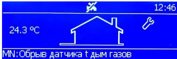
Котлы Wallcon оснащены системой диагностики неисправностей.
