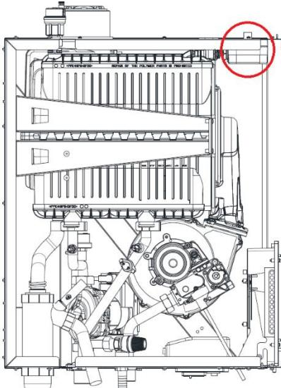
Водогрейные конденсационные котлы **WALLCON X-treme 42-80 кВт** оборудованы реле давления воздуха, подключенным к патрубку дымоудаления.
