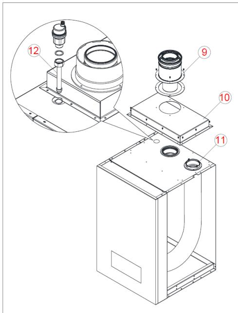
Если в котлах модели WALLCON X-treme применяется соединение дымохода типа С13, С33 (коаксиальный); Используйте комплект из удлинителя воздухоотводчика, адаптера дымохода 80/125 и коаксиальной надставки 80/125.
