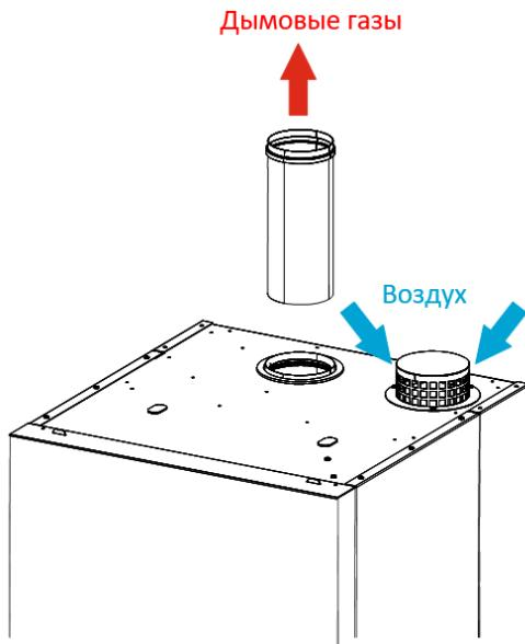
Если необходимо использовать соединение дымохода типа В23, следует использовать переходник для всасывания чистого воздуха, а отработанный газ следует отводить во внешнюю среду через трубу Ø80 мм.
