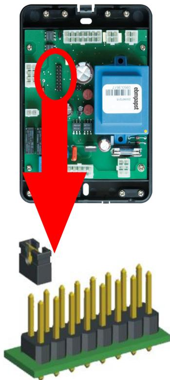
**Установка перемычек для многоконтурных систем**
