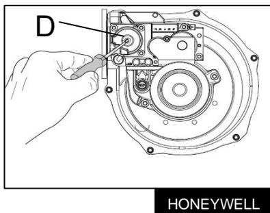
Настройка выбросов при минимальной нагрузке производится путем измерения содержания CO<sub>2</sub> в дымовых газах. Чтобы принудительно перевести котел на минимальную мощность необходимо выполнить следующие шаги.
