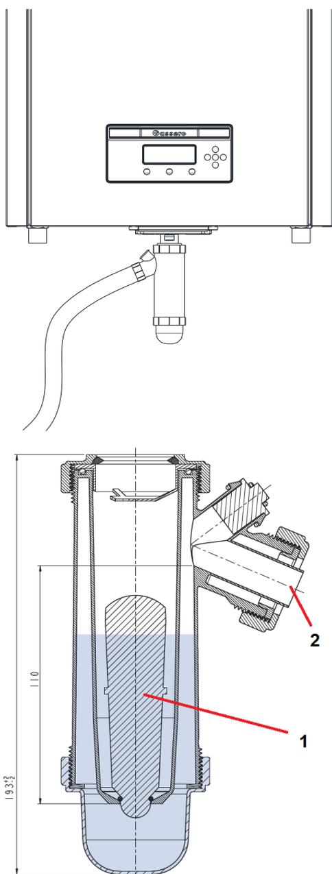
Конденсат, образующийся в процессе сгорания, сливается в систему канализации через сифон и дренажный шланг. Подключение дренажного шланга к системе канализации должно быть выполнено с созданием постоянного уклона и разрывом потока. В качестве альтернативы подключить сливной шланг к устройству нейтрализации конденсата.
