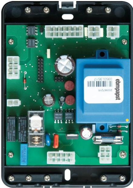
Контроллер котла не может управлять трехходовыми клапанами. Для систем, имеющих трехходовой клапан или дополнительные зоны, необходимо использовать модуль расширения. Различные компоненты системы автоматически распознаются панелью управления и кодировка корректируется автоматически.
