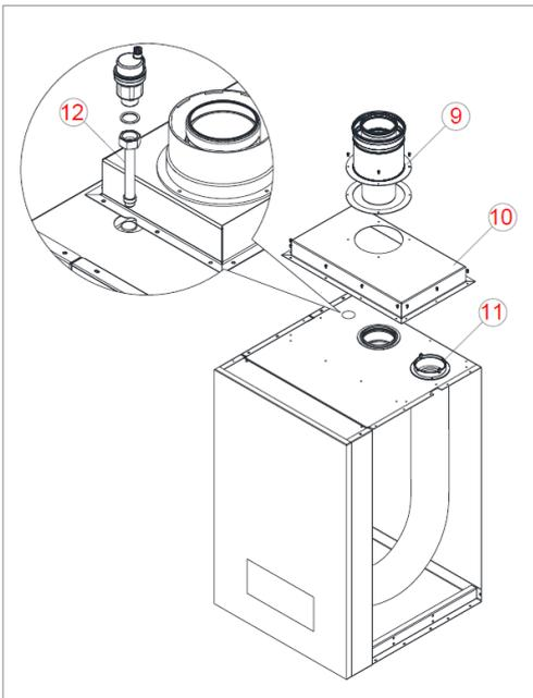
Если в котлах модели ALUCON применяется соединение дымохода типа С13, С33 (коаксиальный); Используйте комплект коаксиального дымохода
