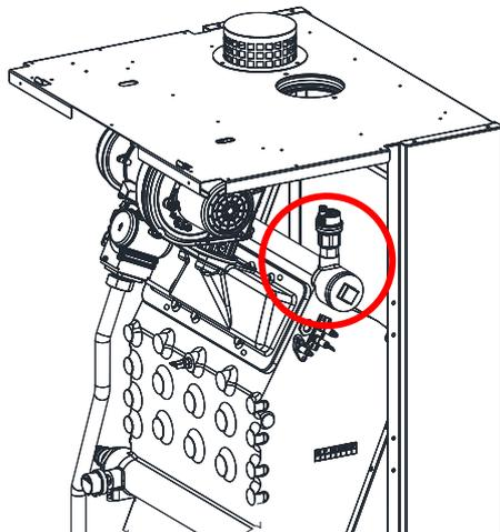
Водогрейные конденсационные котлы **ALUCON** оборудованы автоматическими воздухоотводчиками.
