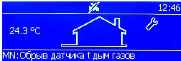
Котлы **Alucon** оснащены системой диагностики неисправностей.
