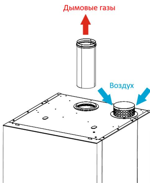
Если необходимо использовать соединение дымохода типа B23, следует использовать переходник для всасывания чистого воздуха, а отработанный газ следует отводить во внешнюю среду через трубу  $\varnothing 100$  мм.
