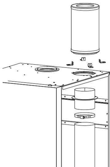
Если ALUCON будет эксплуатироваться в запыленной окружающей среде, то котел должен быть оборудован фильтром входящего воздуха. Этот дополнительный фильтр должен регулярно проверяться.
