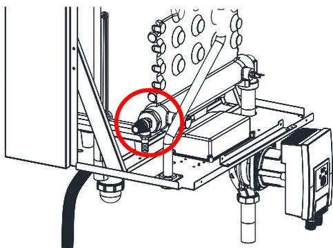
ALUCON оборудован встроенным предохранительным клапаном. Дренажный шланг от предохранительного клапана должен быть подключен к системе канализации.
