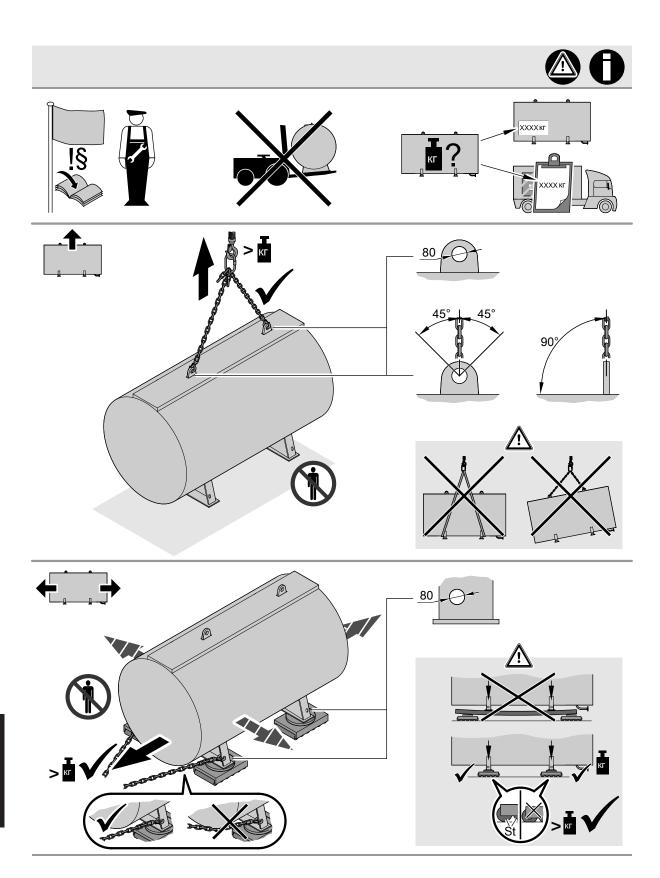
Указание по транспортировке для опоры котла в виде козлов
