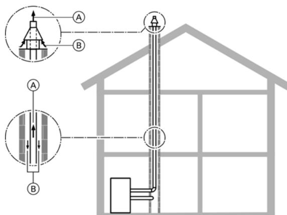
Проход через шахту (конструктивный тип C<sub>33</sub> согласно TRGI '86/96)
