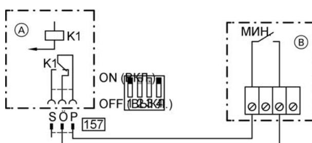
(A) Модуль расширения функциональных возможностей
