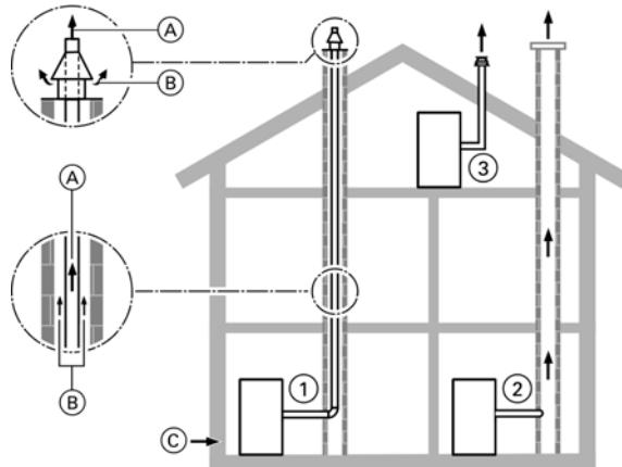
Проход через шахту (конструктивный тип B<sub>23</sub> согласно TRGI '86/96)
