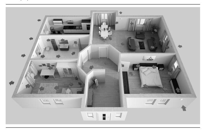
Децентрализованные вентиляционные установки Vitovent 050-D с рекуперацией тепла используются для приточно-вытяжной вентиляции отдельных или одновременно нескольких помещений в жилых зданиях.
