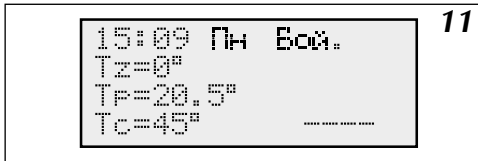
Рис.11 Общий обзор при конфигурации „ОТ.НЕТ ВОД.ДА” (выключен обогрев отопительной системы и включен контур обогрева бойлера).
