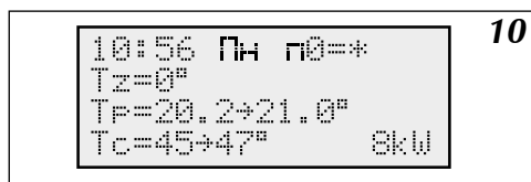
Рис.10 Общий обзор при конфигурации „ОТ.ДА ВОД.ДА“ (включен нагрев отопительной системы и бойлера).
