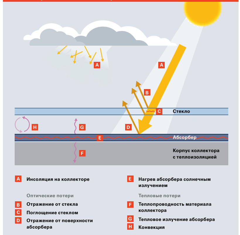
Рис. 8 Энергопотоки в коллекторе
