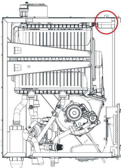
Водогрейные конденсационные котлы **WALLCON X-treme 42-80 кВт** оборудованы реле давления воздуха, подключенным к патрубку дымоудаления.
