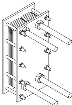
В отличие от гидравлического разделителя вода из системы отопления никогда не смешивается с водой из отопительного котла. В пластинчатом теплообменнике происходит только передача тепла.
