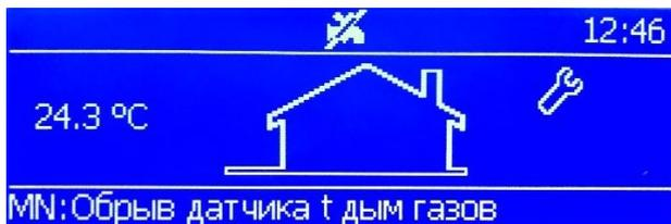
Котлы **Wallcon** оснащены системой диагностики неисправностей.
