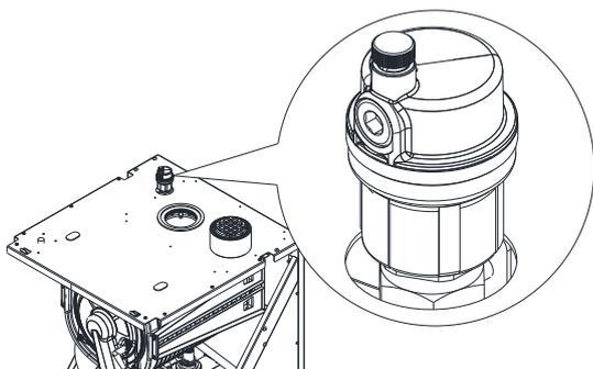
Водогрейные конденсационные котлы **WALLCON X-treme 42-80 кВт** оборудованы автоматическими воздухоотводчиками.
