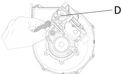
Поверните винт регулировки минимального расхода газа (D) по часовой стрелке, чтобы увеличить значение CO<sub>2</sub>. Если вы повернете его против часовой стрелки, расход газа уменьшится и, следовательно, количество CO<sub>2</sub> тоже уменьшится.
