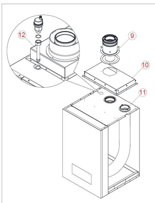
Если необходимо использовать соединение дымохода типа В23, следует использовать переходник для всасывания чистого воздуха, а отработанный газ следует отводить во внешнюю среду через трубу Ø80 мм.
