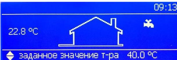
Если вы установили временную программу, вы не можете изменить эту настройку. Если вы хотите управлять котлом/каскадной системой вручную, за исключением временной программы, необходимо установить параметр Меню > Настройки > Clock settings > CH Clock на «Выключено».
