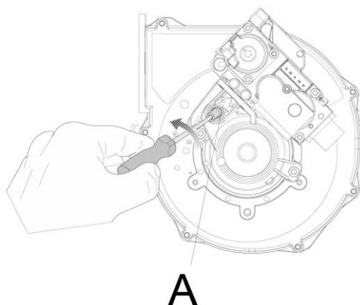
Поворачивайте винт регулировки объема подаваемого газа в номинальном режиме (А) по часовой стрелке для увеличения значения CO<sub>2</sub>. Если поворачивать этот винт против часовой стрелки, то расход газа будет уменьшаться и, таким образом, будет уменьшаться и значение уровня CO<sub>2</sub>.
