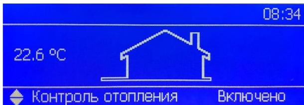
Перейдите в раздел «Контроль отопления» внизу экрана, нажав кнопку на главном экране. Выберите «Включено» или «Отключено» с помощью кнопки . Нажмите кнопку **ENTER** и настройка будет подтверждена.
