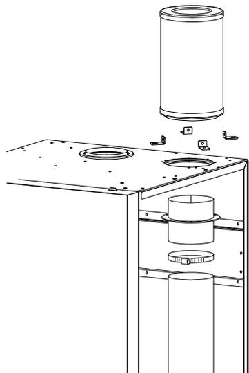
Если WALLCON X-treme будет эксплуатироваться в запыленной окружающей среде, то котел должен быть оборудован фильтром входящего воздуха. Этот дополнительный фильтр должен регулярно проверяться.
