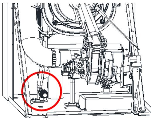
**WALLCON X-treme** оборудован встроенным предохранительным клапаном. Дренажный шланг от предохранительного клапана должен быть подключен к системе канализации.
