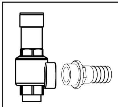
**Alubox X-treme** оборудован встроенным предохранительным клапаном. Дренажный шланг от предохранительного клапана должен быть подключен к системе канализации.
