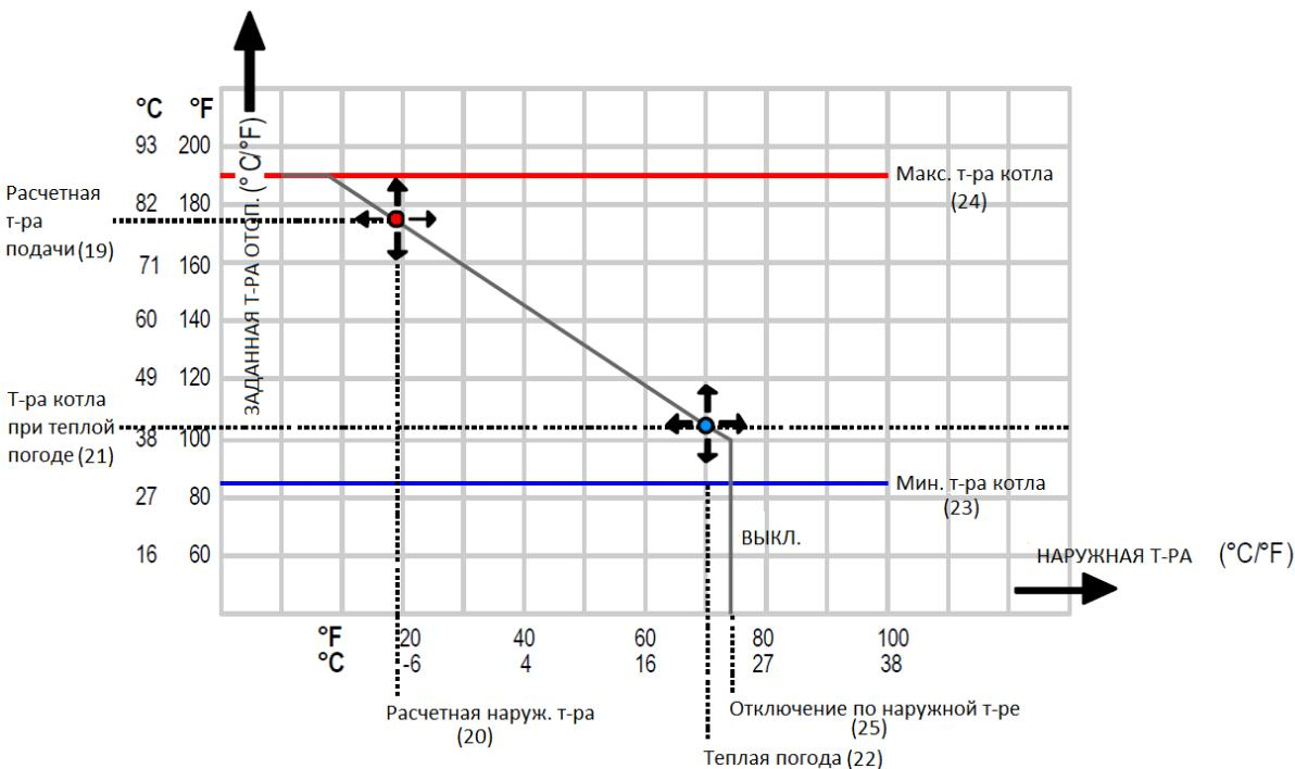
Кривую погодозависимой теплогенерации можно изменить, отрегулировав расчетную температуру и температуру для теплой погоды.
