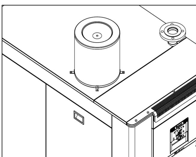
Если ALUBOX X-treme будет эксплуатироваться в запыленной окружающей среде, то котел должен быть оборудован фильтром входящего воздуха. Этот дополнительный фильтр должен регулярно проверяться.
