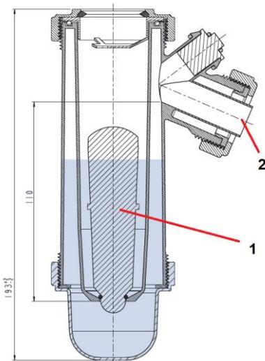
разобрать сифон, удалить поплавок, наполнить сифон водой, собрать и установить сифон на место.
