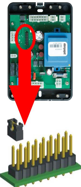
**Установка перемычек для многоконтурных систем**
