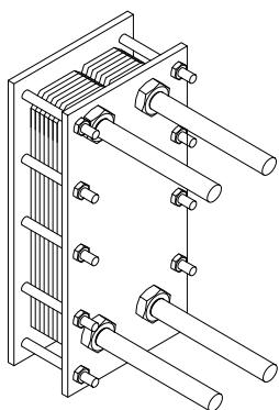
В отличие от гидравлического разделителя вода из системы отопления никогда не смешивается с водой из отопительного котла. В пластинчатом теплообменнике происходит только передача тепла.
