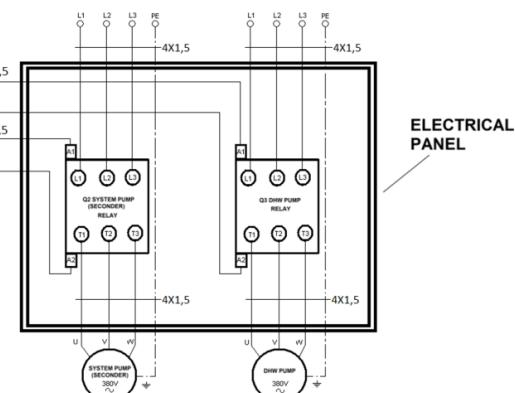
Схема подключения насоса 400В
