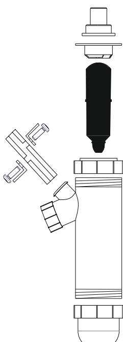
Конденсат, образующийся в процессе сгорания, сливаются в систему канализации через сифон и дренажный шланг. Подключение дренажного шланга к системе канализации должно быть выполнено с созданием постоянного уклона и разрывом потока. В качестве альтернативы подключить сливной шланг к устройству нейтрализации конденсата.
