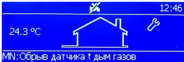
Котлы Ultrabox оснащены системой диагностики неисправностей.
